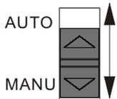
处于MANU模式时, 自动重合功能无效同时清零合闸次数断路器/漏保开关跳闸后只能通过手工合闸。
